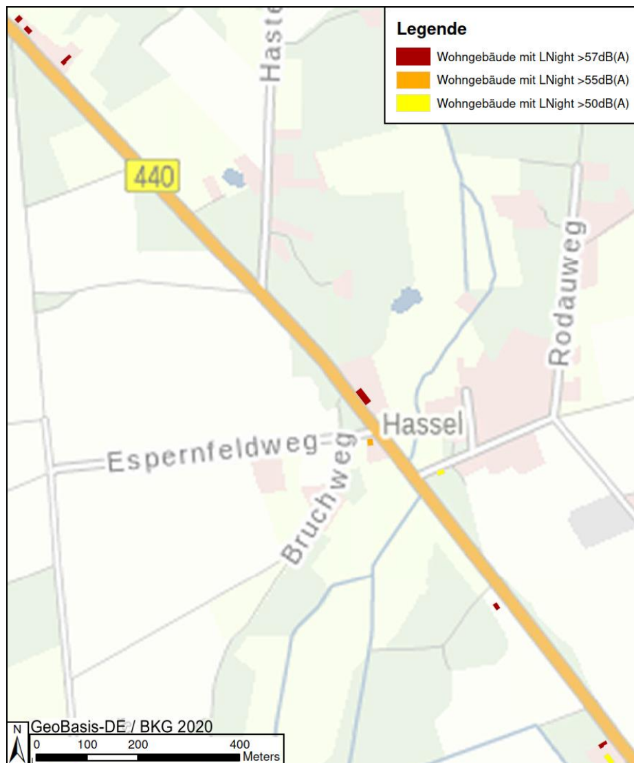
Abbildung 2: Betroffene Wohngebäude an der B440 bei Hassel
